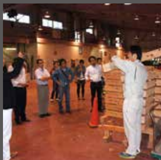
2013年九州大工塾・耐力壁の水平加力試験
