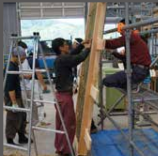
2012年九州大工塾・耐力壁の水平加力試験
